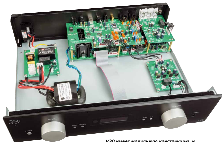
V30 имеет модульную конструкцию, и многие компоненты встречаются и в других моделях AVM
