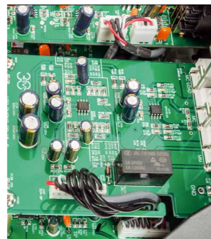
Модуль фоновкорректора похож на отдельный предусилитель-фоновкорректор от AVM
