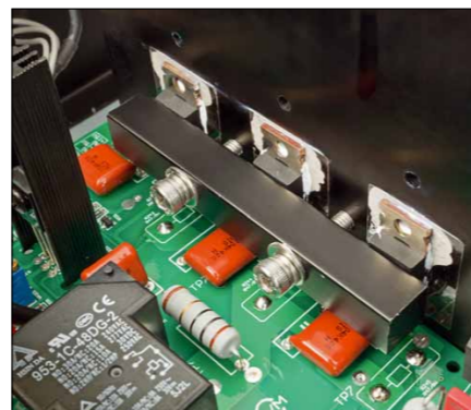
Массивные металлические стержни прижимают выходные транзисторы к радиаторам
