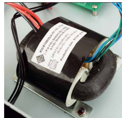
Изящное решение: тороидальный трансформатор питает входной каскад
