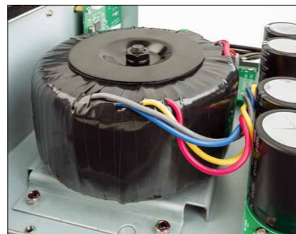
Этот увесистый трансформатор питает выходной моно каскад
